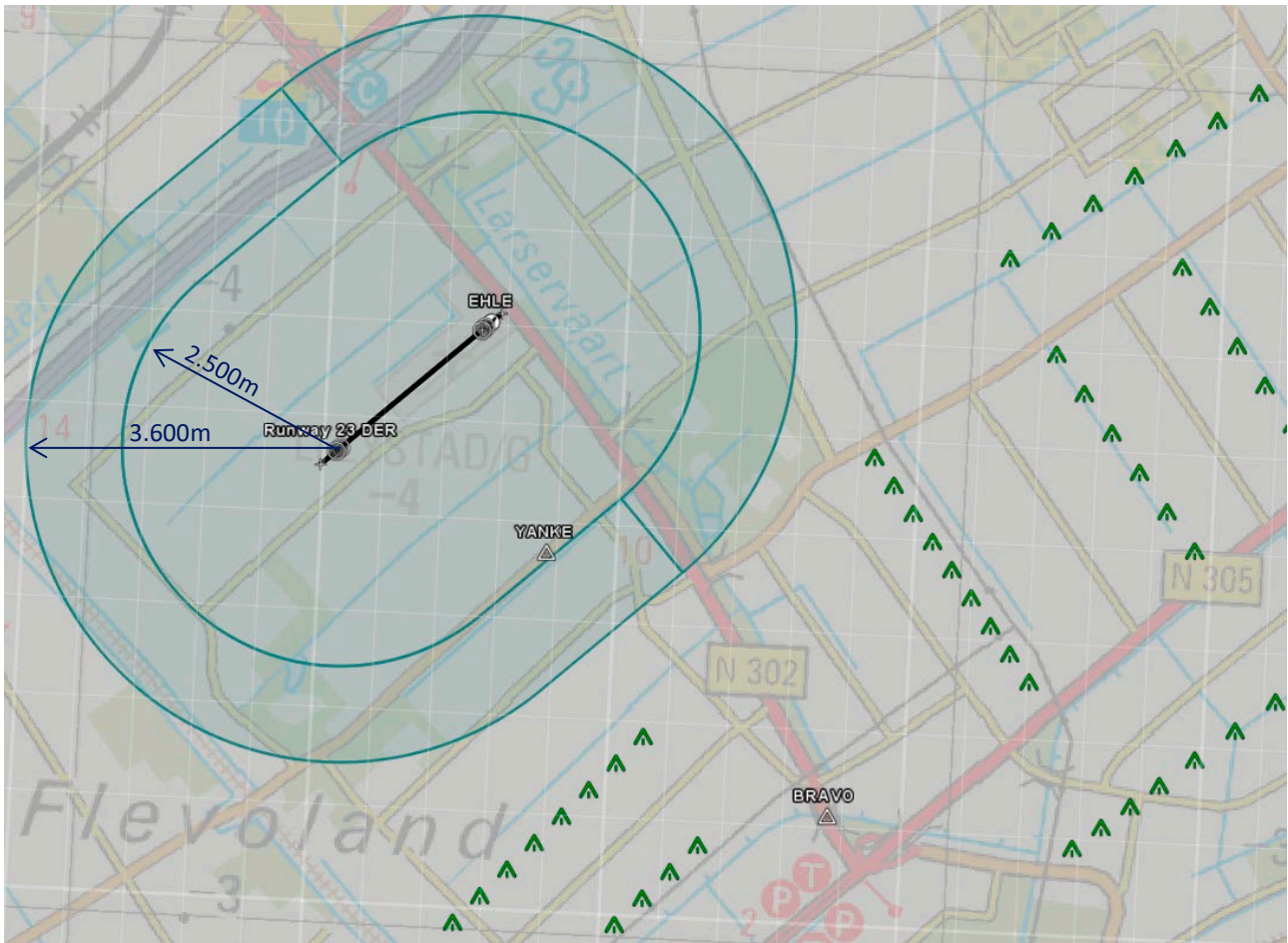
Figuur 4-3: Inner Horizontal en Conical surface voor een non-instrument, code number 2 runway (ICAO Annex 14)
