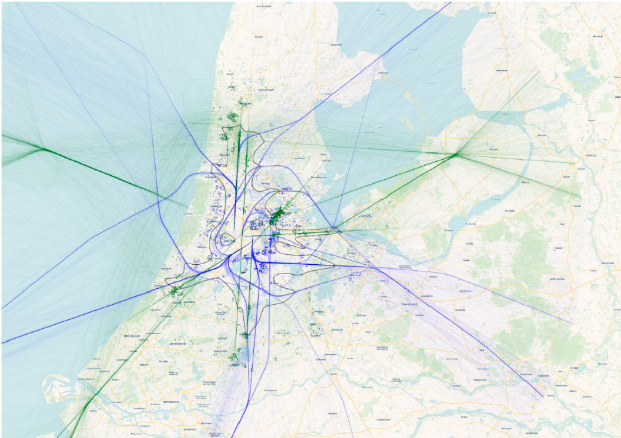
Figuur 9: Geografisch overzicht van de herkomst van de meldingen (weergegeven met stippen) in relatie tot de vliegroutes voor starts (blauw) en landingen (groen). (Bron: BAS)
