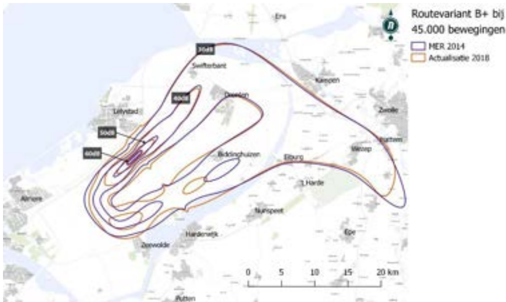
Figuur 18 – De 30 t/m 60 L_{\text{night}} contouren uit het MER2014 en na actualisatie voor routevariant B+ bij 45.000 bewegingen.
